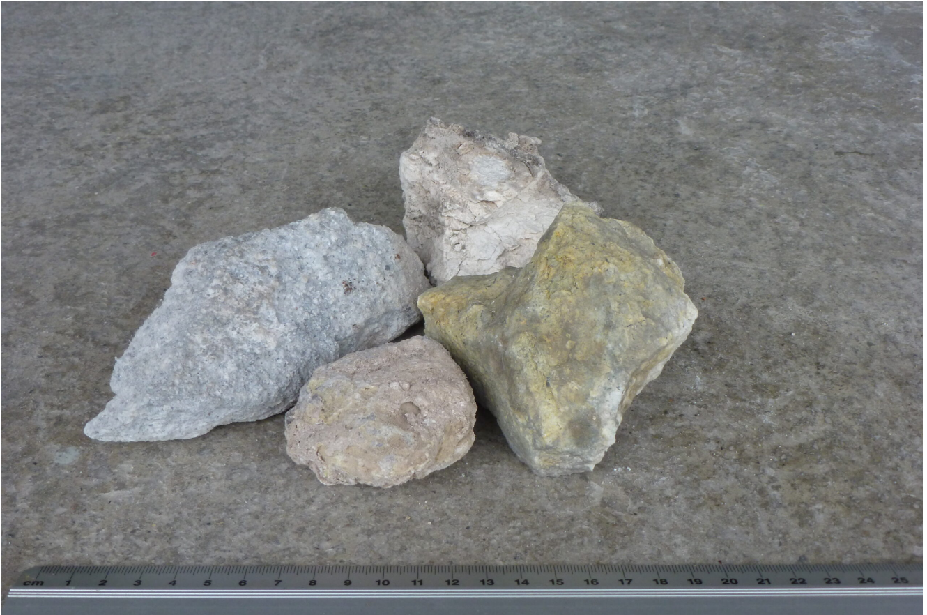
Puzzolangestein aus den phlegräischen Feldern bei Pozzuoli, Neapel, entscheidender Faktor für den während fast 2000 Jahren unübertroffenen römischen Naturbeton. (Foto: Pneumatit AG)
